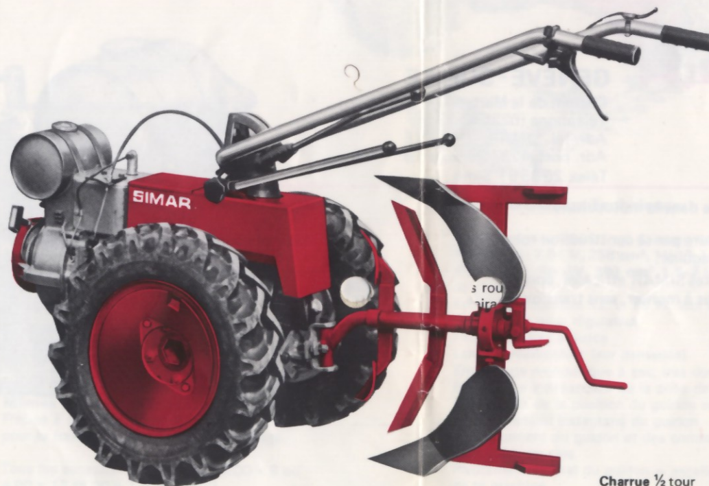
Charrue ½ tour Système de roue libre pour les virages Masses d'alourdissement
