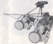
Remorque tôlée C.U. 400 kg Freins à tambour (siège et coffre)
