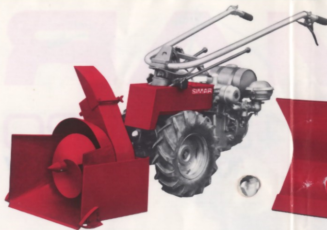
Fraise à neige : largeur 52 cm Cheminée d'évacuation orientable
